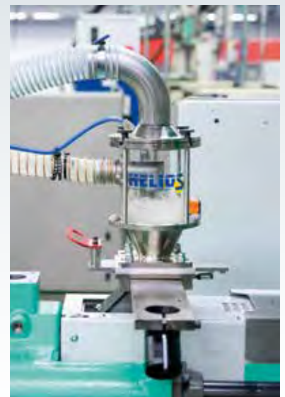
HELIO® Clean 2 auf Verarbeitungsmaschine Steuerungsvariante CE als zweite Förderstelle beim JETBOXX® Trockner
