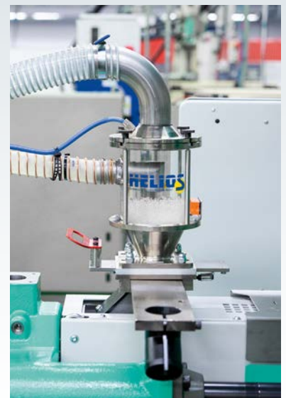
HELIO®Clean 2 auf Verarbeitungsmaschine. Steuerungsvariante CE als zweite Förderstelle im JETBOXX® Trockner enthalten.
