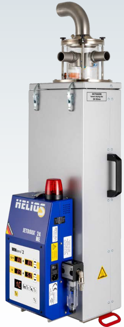
JETBOXX® Mini Set 24 Liter Beispiel: 2K-Fördergerät mit Entstaubung Durchsatz : bis 4,8 kg/h
