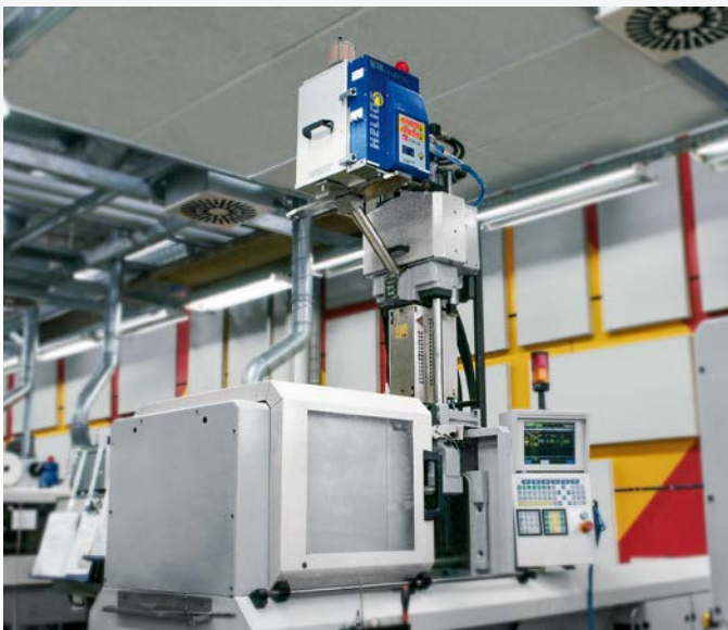
20 Liter auf vertikaler Spritzeinheit
