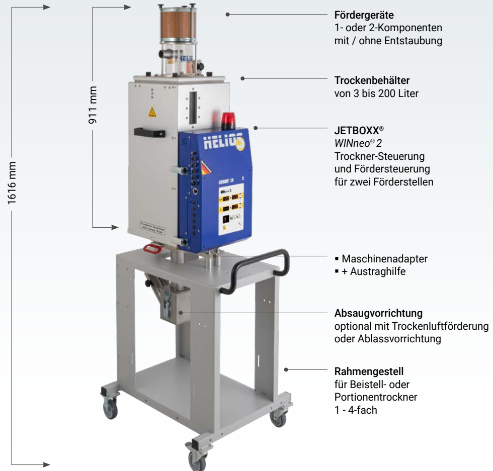
JETBOXX® 30 Liter Materialdurchsatz bis 6kg/h
